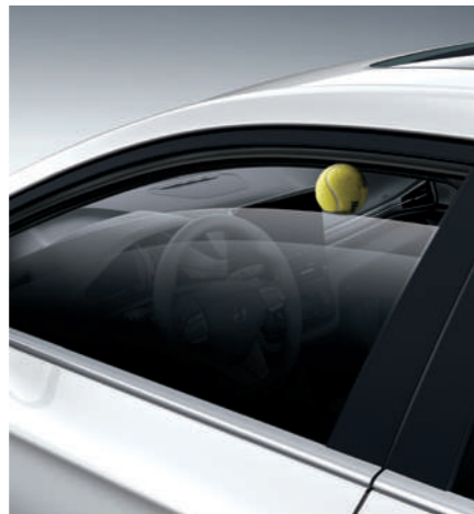
Kontrole bezbednosnih električnih prozora
