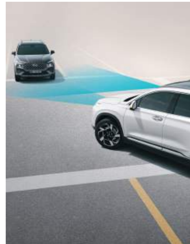
Pomoć u izbegavanju frontalnog sudara (FCA sa skretanjem na raskrsnici) FCA sistem vas upozorava i automatski koči kada se detektuje iznenadno kočenje vozila ispred ili kad se detektuju pešaci ili biciklisti na vašem putu. Isto se odnosi na rizike od sudara sa vozilima koja vam dolaze u susret kad skrećete levo na raskrsnici.
