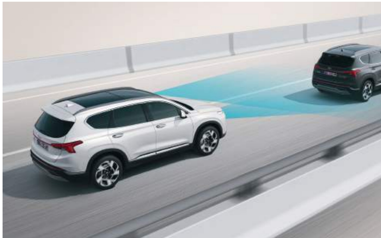
Pomoć u vožnji auto-putem (HDA) Budite u sredini vaše trake i putujte na bezbednoj udaljenosti iza vozila ispred kad su Pametan tempomat ili Pomoć u praćenju trake aktivirani.
