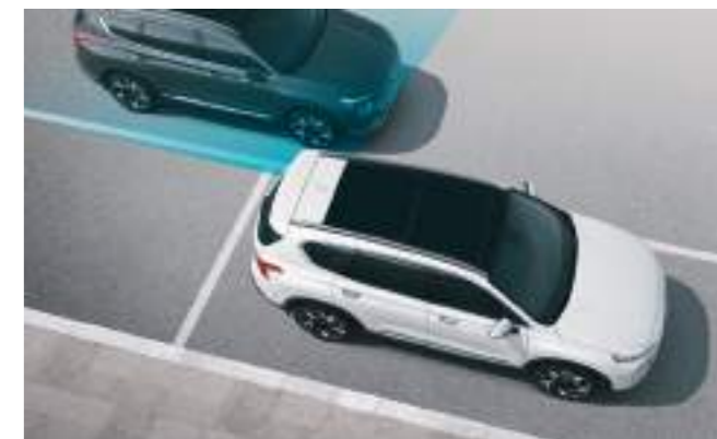
Pomoć u izbegavanju sudara u mrtvom uglu (BCA) Koristeći radarske senzore u donjem braniku i prednju kameru, sistem vas upozorava na saobraćaj u području mrtvog ugla. Ako uključite indikator skretanja u takvoj situaciji, sistem će vas zvučno upozoriti i kočiti da spreči sudar.
