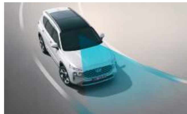
Navigacija zasnovana na Pametnom tempomatu (NSCC) Koristi najsavremeniji navigacioni sistem da predvidi predstojeće krivine ili prave deonice auto-puta i automatski prilagodava brzinu za bezbedniju vožnju.
