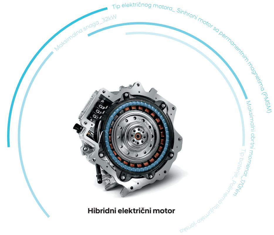
Hibridni električni motor
